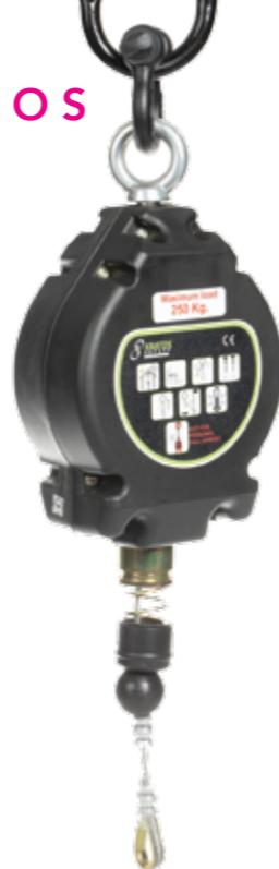
Les anti-chutes de charges de la marque se distinguent par un carter polymère haute résistance, un système d'arrêt rapide avec multi-cliquets, ainsi qu'un absorbeur d'énergie intégré, réduisant les efforts sur la structure.
