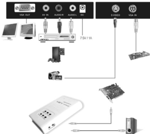
Raccorder une console de jeu en raccordant les sorties vidéo et audio aux entrées respectives sur le **VASMON3**. Enfoncer la touche PC/VIDEO sur le **VASMON3** pour commuter vers le canal A/V.
