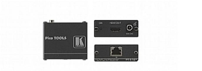
Le PT-572+ est un récepteur paires torsadées DGKat™ pour signaux HDMI. L'émetteur PT-571 convertit un signal HDMI au format paires torsadées et le récepteur PT-572+ restitue le signal HDMI d'origine.
