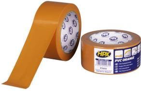
HPX PVC ORANGE est un ruban de protection orange avec pouvoir adhésif élevé pour les travaux de construction et crépissage . Il se compose d'un support en film PVC lisse, stable, conformable et résistant à la déchirure . Il a une bonne adhérence sur beaucoup de surfaces grâce à sa colle agressive à base de caoutchouc. Déchirable à la main et bonne résistance aux UV (jusqu'à 2 semaines)
