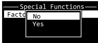
02) Appuyez sur les boutons **UP/DOWN** pour choisir entre Non et Oui. Si vous choisissez Oui, les paramètres de l'appareil seront réinitialisés aux paramètres d'usine par défaut.
