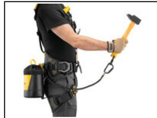
TOOLINK S est une interface qui permet de connecter et de sécuriser un outil sans œillet ou à manche lisse et droit, jusqu'à 2,3 kg, à l'aide de l'adhésif fourni TOOLTAPE.
