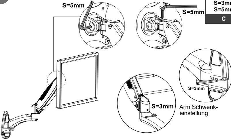
Verwenden Sie einen Innensechskantschlüssel, zur Einstellung der Beweglichkeit. Drehen Sie gegen den Uhrzeigersinn, um sie zu verringern und im Uhrzeigersinn, um sie zu erhöhen.
