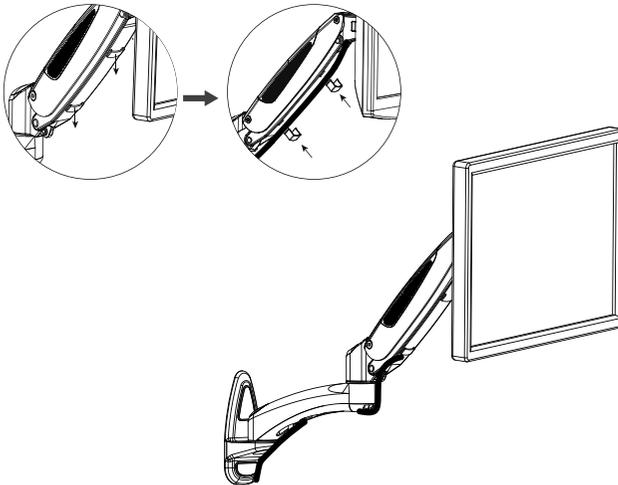
Führen Sie die Kabel in die Kabelabdeckungen ein. Lassen Sie den Kabeln, für eine optimale Einstellung, genügend Spielraum an den Gelenken.
