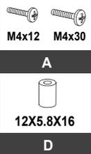
**Abgesetzte Montage:** Legen Sie die 4 Abstandshalter zwischen die VESA-Halterung und den Monitor. Montieren Sie die VESA-Halterung, mit den 4 Schrauben durch die Abstandshalter am Monitor.
