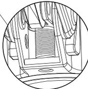
Prüfen Sie das Gewinde. Verstellen Sie die Schraube im Uhrzeigersinn, wird das Gewinde länger und die Last wird leichter. Verstellen Sie die Schraube gegen den Uhrzeigersinn, das Gewinde wird kürzer und die Last wird schwerer. Sie müssen möglicherweise mehrere Zyklen durchführen, um die perfekte Position zu erreichen.
