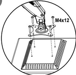
**Bündige Montage:** Montieren Sie die VESA-Halterung mit den 4 Schrauben am Monitor.
