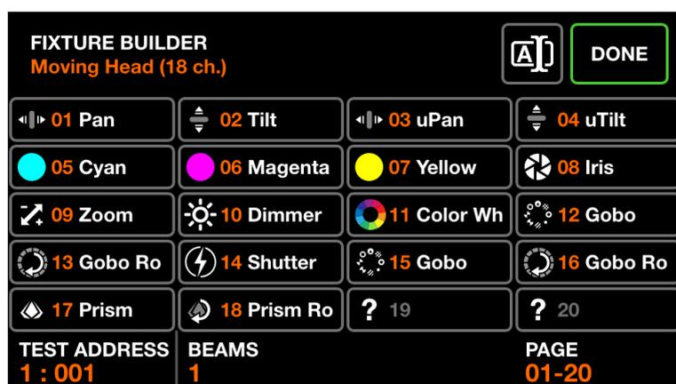
Le constructeur d'appareils est utilisé pour créer des profils de projecteurs. Un profil de projecteur est une liste de canaux et de fonctionnalités associés à un projecteur particulier.
