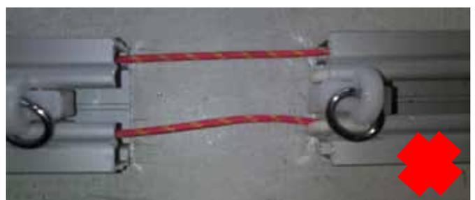
4 - Avant de mettre le moteur en position sur le rail, s'assurer du bon sens de rotation et du bon fonctionnement des contacts N°1 et N°2, en plaçant le conducteur pilote au centre des contacteurs.
