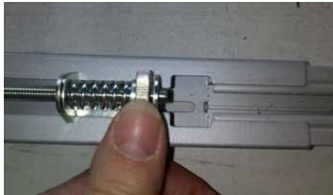
3 - Vérifier que les suspendeurs soient libres et que le câble ne les bloque pas.
