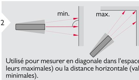
Utilisé pour mesurer en diagonale dans l'espace (valeurs maximales) ou la distance horizontale (valeurs minimales).
