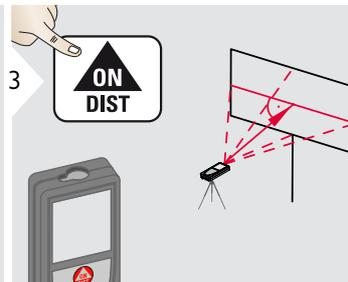
Viser à angle droit la ligne centrale horizontale de la surface. Cette zone doit être parfaitement plane dans le plan vertical.
