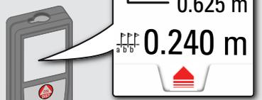
Lorsqu'on approche un piquetage à moins de 0,1 m, des bips se font entendre. Le bouton SUPPRESSION/ARRET permet d'arrêter la fonction.
