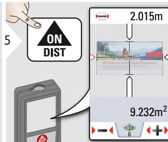
Sélectionner des flèches avec les touches directionnelles ou en effleurant l'écran et réglant avec les touches virtuelles. La surface correspondante est calculée.
