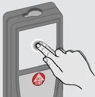
Effleurer l'écran pour ouvrir un bouton d'écran ou pour faire une sélection. Un effleurement de l'icône au milieu de la ligne du bas active la mesure de distance ou déclenche l'appareil photo.
