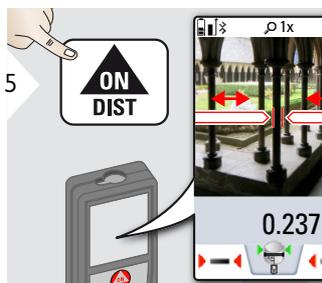
Sélectionner des flèches avec les touches directionnelles ou en effleurant l'écran et réglant avec les touches virtuelles. Le diamètre correspondant est calculé.
