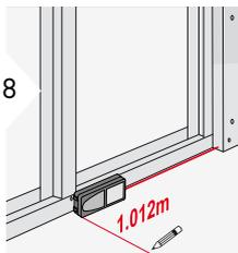
Déplacer l'appareil lentement le long de la ligne de piquetage. La distance jusqu'au piquetage suivant s'affiche.
