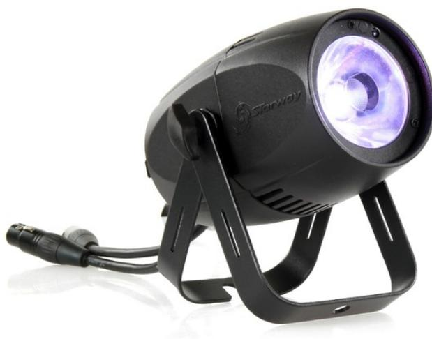
F1 Kolor HD est un projecteur LED RVBW 15W doté d'un angle d'ouverture de 4°. Il signe le retour de l'effet PAR 36 en apportant tous les avantages de la LED RGBW, du contrôle par DMX et du pilotage par télécommande IR. Un jeu de filtres livré avec le projecteur permet d'obtenir un éclairage de type wash pour faire varier les plaisirs.
