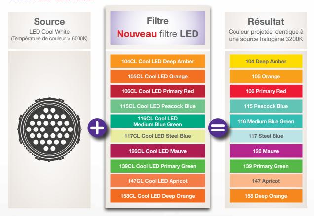
Pour de meilleurs résultats, utilisez une source homogène (avec lentille de sortie unique)
