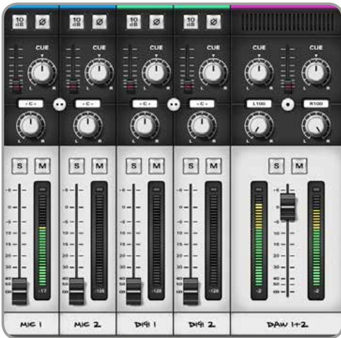
Les canaux des entrées **analogiques** reçoivent les entrées microphone, ligne ou D.I. [canal 1].
