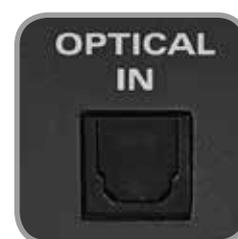
En mode S/PDIF, l'entrée optique offre la possibilité d'intégrer un préampli micro externe, pour 2 canaux audio jusqu'en 96 kHz.
