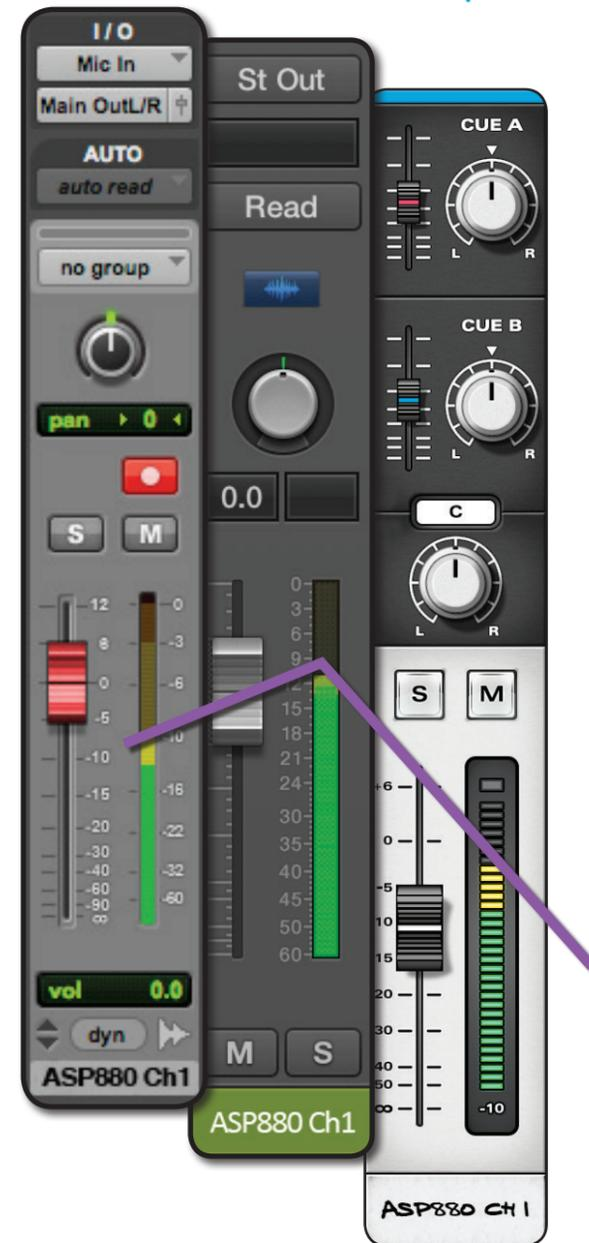
L'affichage de niveau sur l'ASP880 signalera la présence d'un signal à -28 dB FS (-10 dBu) et préviendra de potentielles saturations à -2 dB FS (+16 dBu). Toutefois, vous ne devez vous baser que sur l'enregistreur de destination pour une mesure précise.
