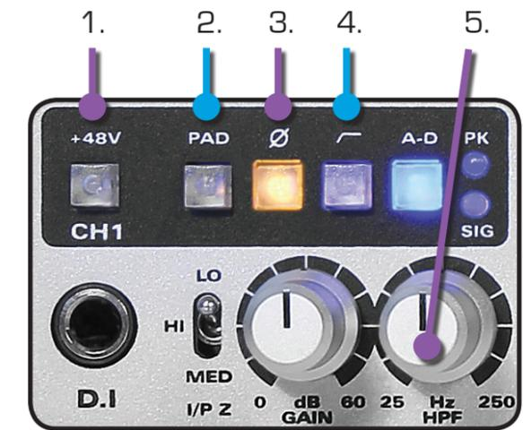
Pour vérifier la cohérence des phases dans des configurations à multiples micros, commencez toujours par placer soigneusement les micros puis enclenchez le commutateur Ø (3) sur diverses combinaisons de canaux pour trouver celle donnant la représentation la plus pleine et la plus solide des basses fréquences de la source.
