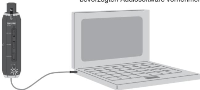
**Hinweis:** Stellen Sie sicher, dass ein USB-Anschluss mit Versorgungsspannung verwendet wird.
