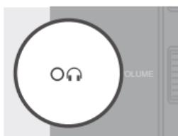
Die Kopfhörerbuchse ermöglicht ein direktes Abhören des Mikrofonsignals beim Aufnehmen ohne jegliche Verzögerung, die auftreten würde wenn dieses Signal über den Kopfhörerausgang des Computers abgehört würde.
