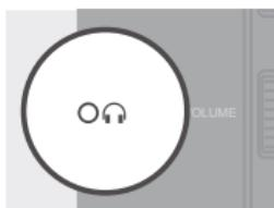
PCを通さず、ヘッドホンジャックからダイレクトにマイクの音声信号をモニタリングすることによって、PCのヘッドホン出力からモニタリングする場合に起こるレイテンシーを回避することができます。
