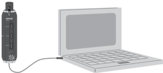
注意：请确定所连接的USB接口已接通电源。
