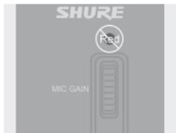
MIC GAIN (Mikrofonverstärkung) verringern, falls die Anzeige des Spitzenwert-Pegels irgendwann rot aufleuchtet.
