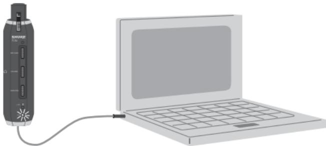
注:USBハブをご使用時に、電力が不足する場合がありますので、できるだけ直接パワードUSB端子に接続してください。
