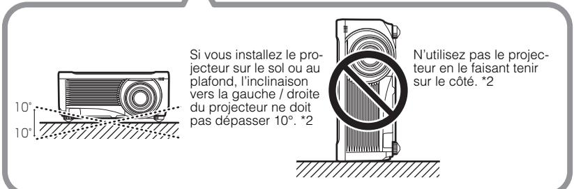
Si vous installez le projecteur sur le sol ou au plafond, l'inclinaison vers la gauche / droite du projecteur ne doit pas dépasser 10°. \*2
