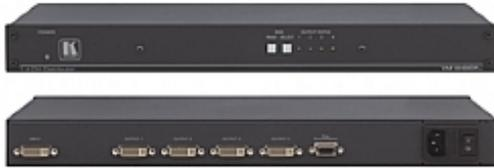
Le VM-4HDCPxI est un distributeur amplificateur de haute qualité pour signaux DVI. Il reclocke et égalise un signal en entrée et le distribue sur quatre sorties identiques.
