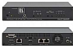
Le VM-114H2C est un sélecteur et distributeur amplificateur haute performance pour signaux HDMI et paires torsadées DGKat™. Il reclocke et égalise un des deux signaux d'entrée (HDMI ou paires torsadées) puis le distribue vers deux sorties HDMI et deux sorties paires torsadées DGKat™.
