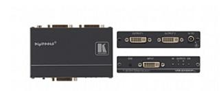
Le VM-2HDCPxI est un distibuteur amplificateur conforme HDCP pour les signaux DVI-D de résolution jusqu'à WUXGA et 1080p. Il reclock et égalise le signal et le distribue vers deux sorties identiques.
