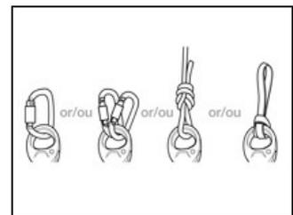
L'émerillon peut recevoir jusqu'à trois mousquetons et permet l'utilisation de cordes et de sangles pour faciliter les manoeuvres.
