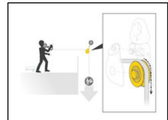
La poulie permet la mise en place de déviation de charge lourde, en complément d'un descendeur.
