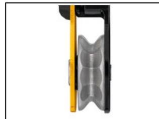
Le réa à facettes dispose d'un sens de rotation unique procurant un excellent rendement au hissage et ajoutant des zones de frottement avec la corde pour un freinage supplémentaire à la descente.
