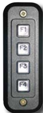
Exemple de panneau de contrôle utilisant les ports d'entrées.
