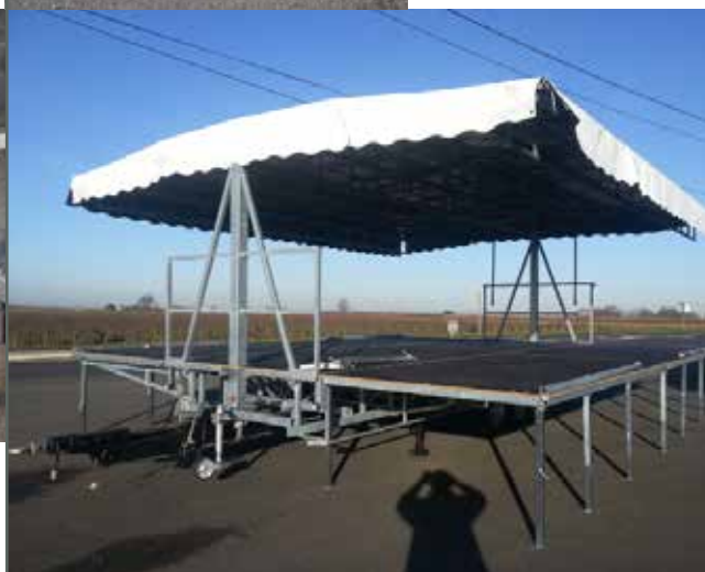
Scène ouverte en position basse pour l'accroche des projecteurs et des bâches latérales
