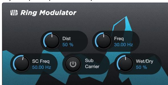
1. **Dist.** Contrôle le degré de distorsion en partant de zéro pour aller jusqu'à dépasser les bornes.
