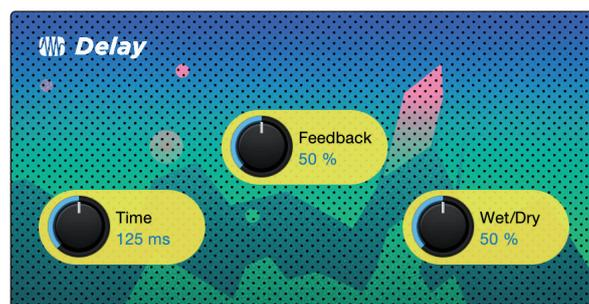
1. **Time.** C'est le temps (en millisecondes) qui sépare le signal source de son écho. L'effet de delay le plus simple est une répétition unique. Un court retard compris entre 30 et 100 ms peut être utilisé pour créer un simple écho de doublage tandis que des temps de retard plus grands produisent un écho plus distant.
