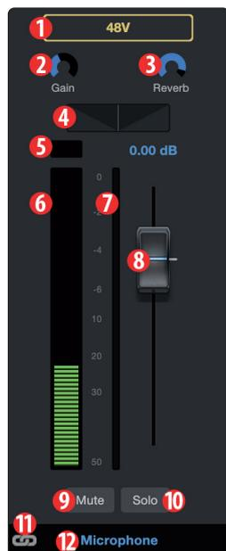
1. **+48 V.** Active/désactive l'alimentation +48 V pour une utilisation avec des microphones électrostatiques comme les PX-1 ou M7 de PreSonus.
