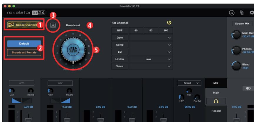
1. **Hot Key.** Cette mémoire de preset vous permet de conserver un réglage pouvant être utilisé à la volée. Il supprime le preset actif et doit être désactivé pour pouvoir à nouveau utiliser les autres presets. C'est parfait lorsque vous souhaitez donner rapidement un effet à votre voix.
