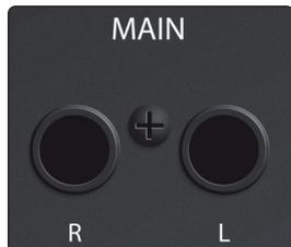
**Sorties principales.** Ce sont les sorties principales de la Revelator io24. Le niveau de ces sorties principales est contrôlé par la commande de niveau général en face avant de l'unité. Les flux de lecture 1 et 2 sont envoyés à ces sorties.
