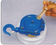
1. Dévisser les deux vis M6 et retirer le capot du flasque côté entrée.
