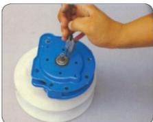
6. Retirer le circlip sur le flasque côté entrée.
