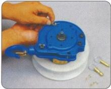
2. Retirer les goupilles d'arrêt côté entrée et du carter des galets presseurs.
