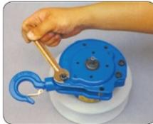
3. Enlever le crochet et retirer le frein d'écrou et dévisser le boulon hex.
