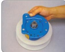
13. Enlever le flasque côté sortie de l'axe de sortie.
