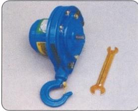
Vérifier s'il y a des signes d'abrasion ou de détérioration sur les pignons, bagues, paliers, arbre ou gorge de poulie.
