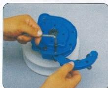
4. Enlever le boulon hex. (M8) et l'écrou, puis le carter des galets presseurs d'entre les flasques
