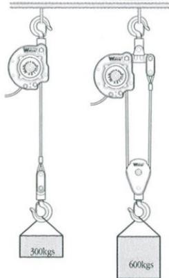
Fixer le corps principal à une poutrelle en I, poutrelle ronde ou autre structure aérienne stable et accrocher la charge avec le câble pour la déplacer verticalement.
