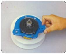
9. Retirer le circlip de fixation de la poulie sur l'axe de sortie.
