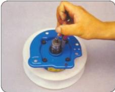
11. Enlever le circlip de fixation du flasque côté sortie sur l'axe de sortie
