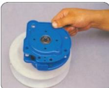
7. Retirer le flasque côté entrée de l'axe de sortie
