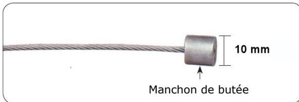
Fixer l'autre bout du câble au cube d'acier par manchonnage. L'épaisseur de l'acier doit être supérieure à 10 mm après manchonnage. Enlever par meulage l'excès de câble de la terminaison par manchon de butée.
