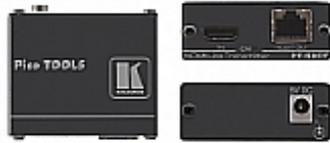
Le PT-580T est un émetteur sur Paires Torsadées HDBaseT pour signaux HDMI (compatible 4K). L'appareil accepte un signal HDMI puis le convertit en signal paires torsadées. Un récepteur HDBaseT (par exemple le TP-580R ou WP-580R) convertit le signal paires torsadées en signal HDMI formant ainsi un ensemble émetteur/récepteur.
