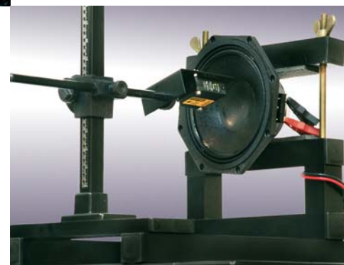
Ci-dessous: Dispositif d'analyse au laser permettant d'évaluer les transducteurs à cône tels que le haut-parleur de basses neodymium du PS10
