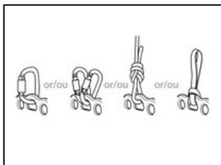
Les trous sont compatibles avec le passage des cordes ou des sangles pour une connexion directe.
