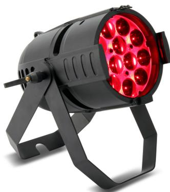
Le Rush PAR 2 RGBW Zoom est un PAR à LEDs à lentille unique avec couleurs prémixées. Il dispose de 12 LEDs RGBW et un zoom spectaculaire de 10 à 60°. Il propose un gradateur électronique et un stroboscope. Sa lyre multifonction est utilisable comme support au sol ou comme suspension.
