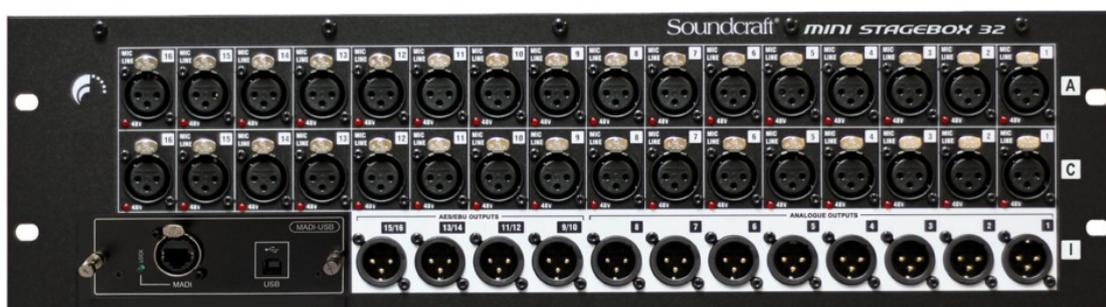
Le rack de scène Mini Stagebox 32 R procure une solution de connectivité simple sur scène pour un budget économique. Il propose, dans un rack 3U, 32 entrées micro/ligne et 8 sorties ligne symétriques sur XLR et 4 sorties AES/EBU. Il se connecte à toutes les consoles numériques Soundcraft Si Expression, Si Compact, Si Performer, Si et Vi grâce à sa carte de connexion MADI via une liaison par câble Cat 5. Cette carte offre également une connexion USB.
