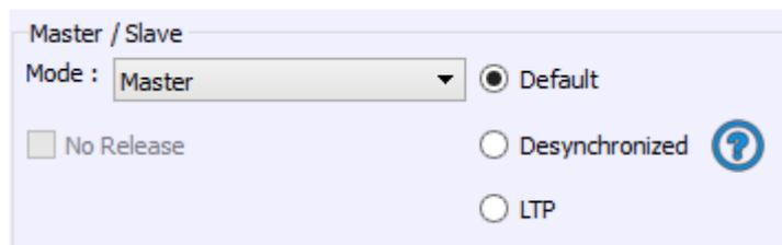
Le mode autonome permet configurée les interfaces en maître ou esclave lorsque plusieurs interfaces sont connectées sur les ports USB. Ce mode permet de connecter entre eux plusieurs appareils et ainsi augmenter le nombre d'univers (jusqu'à 32 univers). Les interfaces sont toujours ordonnées par ordre croissant des numéros de série.
