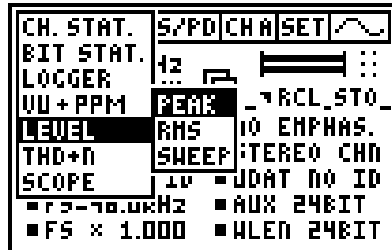
Fig 5-40, Menu de sélection de la mesure du niveau (Level)
