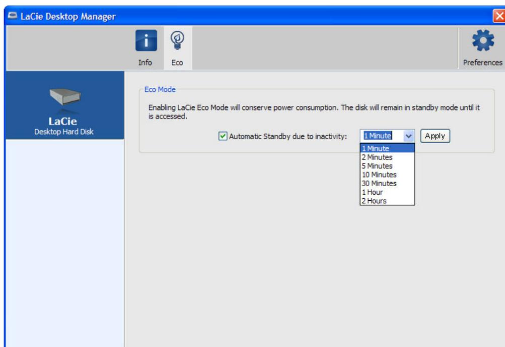
**Mode Eco et Mac OS X :** Selon la configuration de votre disque dur LaCie, Le mode Eco peut être géré par Mac OS X. Si c'est le cas, cliquer sur Paramètres d'économie d'énergie pour accéder aux Préférences Système. Sélectionner "Mettre les disques durs en état de veille lorsque c'est possible" pour conserver de l'énergie.
