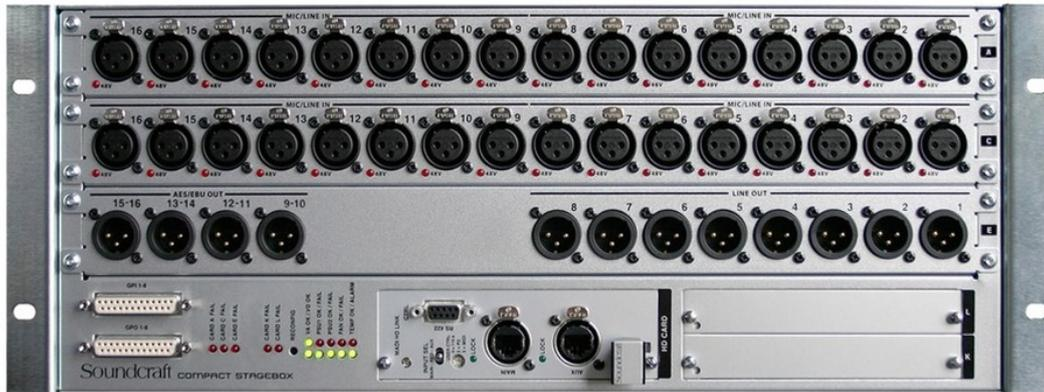
Rack de scène compact 32 mic/8 out analog+8 aes, Cat5 Le Compact Stage Box est un rack de scène compact. Il occupe 4 unités de haut et comporte : 32 XLR femelle pour les entrées micro, 8 XLR mâle pour les sorties analogiques, 4 XLR mâle pour les sorties numériques au format AES/EBU. Il dispose en plus de 2 slots d'extension : le premier slot reçoit la carte MADi bridge (double emplacement) et le second sur la droite peut recevoir deux cartes simple format ou une double format
