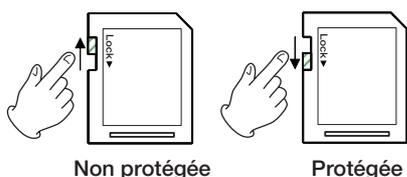
Si le commutateur de protection est glissé en position "LOCK", il n'est pas possible d'ajouter ou de modifier des fichiers. Pour enregistrer, effacer ou changer d'une quelconque façon les fichiers, déverrouillez cette protection contre l'écriture.
