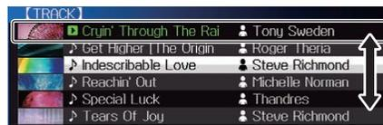
Une pression d'au moins 1 seconde sur le sélecteur rotatif permet d'utiliser la fonction de saut.
