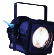
F101 13 - 59° - 1000/1200 W Lentille Fresnel Ø 150 mm
