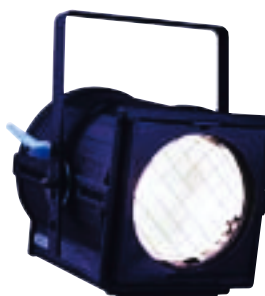
F101 13 - 59° - 1000/1200 W Lentille Fresnel Ø 150 mm
