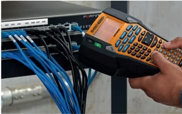
Permet d'imprimer des étiquettes jusqu'à 24 mm de largeur en nylon souple et résistant de qualité industrielle, en polyester permanent, en vinyle Rhino™, ainsi que des gaines thermorétractables, des étiquettes non-adhésives et des étiquettes Rhino™ laminées
